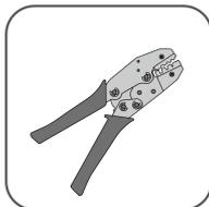
Alicate de crimpagem de terminal de tubo (0,5 mm<sup>2</sup> a 1,0 mm<sup>2</sup>)
