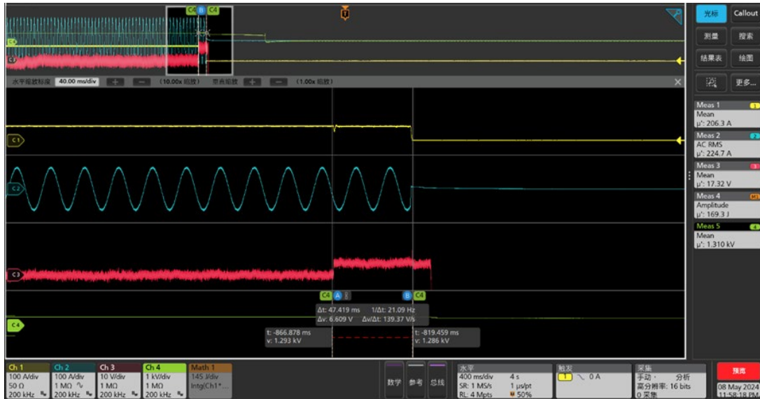
图18 并网充电单支路最大电流模式下实验波形图
