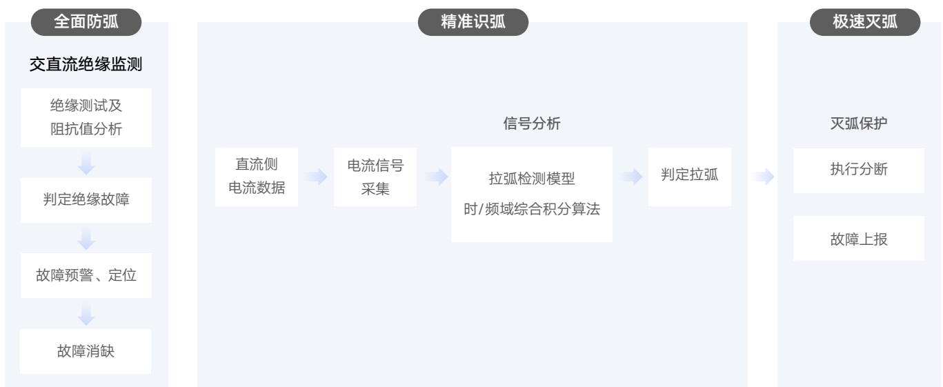
图12 ArcDefender™储能直流拉弧技术方案
