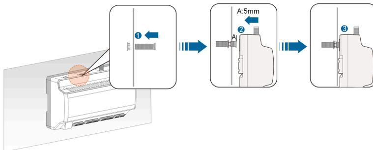
**步骤 5** 将Logger1000背面的两个安装孔扣在螺钉上。
