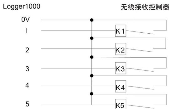
图 13-3 Logger1000与无线接收控制器连接示意图
