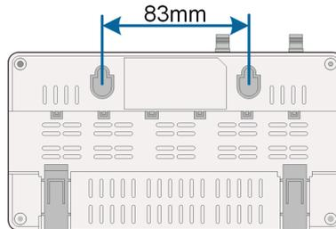
图 4-3 挂墙安装孔尺寸
