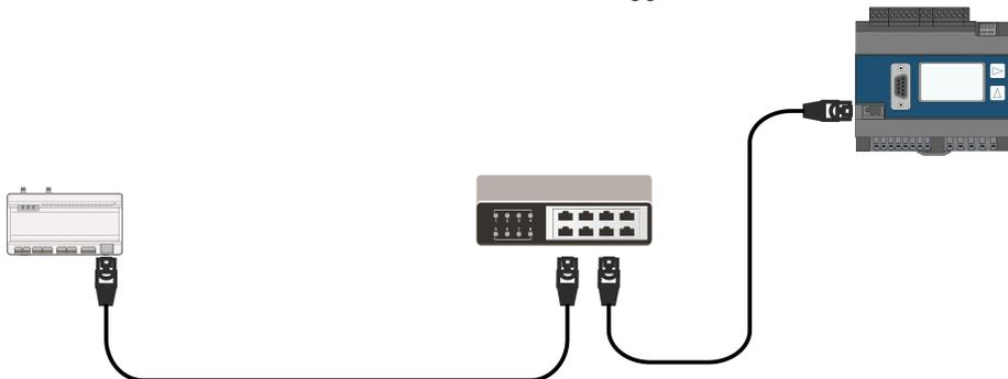
**步骤 3** 可选：如不使用交换机，将电表引出的网线直接连接至Logger1000的“ETH”端口。
