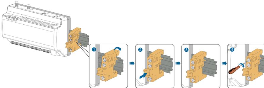
步骤 5 轻轻晃动Logger1000，确认安装牢固。
