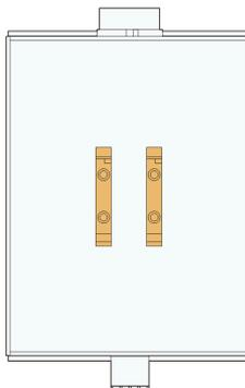
**步骤 1** 略微倾斜电源盒，将电源盒背面的卡扣卡入导轨。
