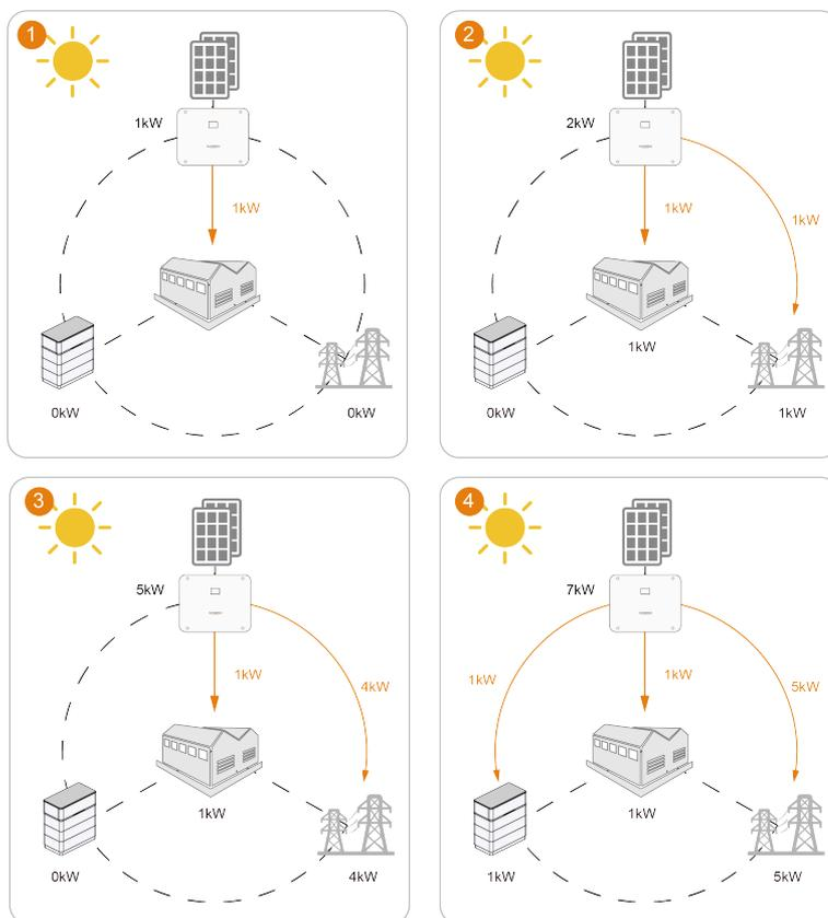
图 15-1 供电顺序（假设需量馈电阈值为5kw）
