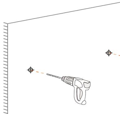
步骤 3 如在混凝土墙面上安装，使用膨胀螺栓套组固定Logger1000，确保螺钉高于墙面约5mm。
