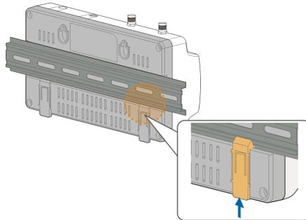
步骤 4 在Logger1000两端的导轨上安装终端固定件，确保Logger1000与导轨不会相对移动。
