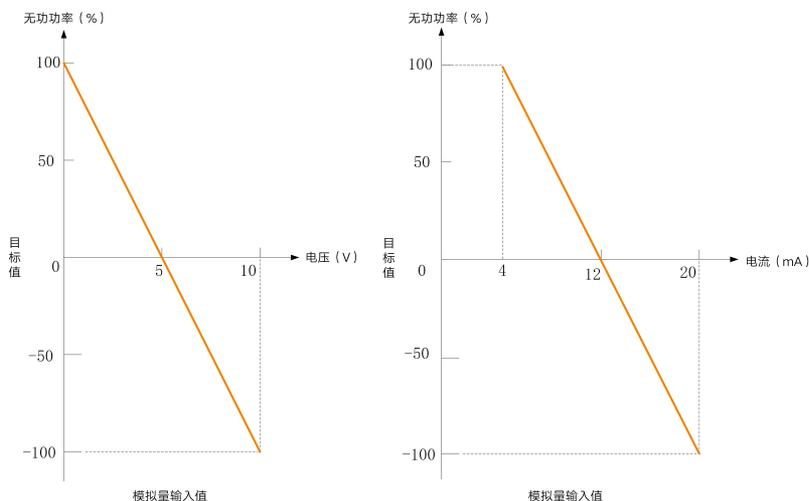
图 13-10 模拟量输入值与目标值的对应关系示例
