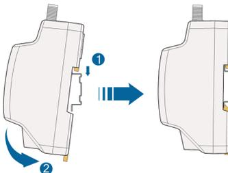
步骤 3 上推卡扣，确保Logger1000与导轨连接紧固。
