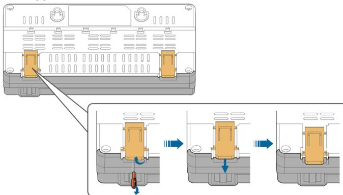
**步骤 2** 略微倾斜Logger1000，将Logger1000背面的卡勾卡入导轨。
