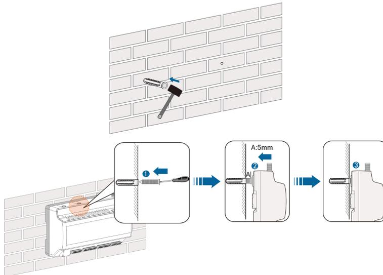
**步骤 4** 如在金属墙面上安装，使用螺栓螺母的紧固件组合固定Logger1000，确保螺钉高于墙面约5mm。
