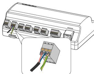
**步骤 5** 将从Logger1000 “24V IN” 端口引出的直流线缆连接至电源盒 “DC 24V OUT” 端口。
