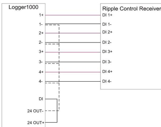
图 13-5 无功功率干节点连接示意图
