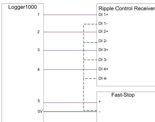
图 13-4 有功功率干节点连接示意图
