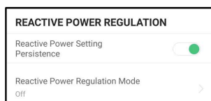
Figure 8-19 Régulation de la puissance réactive
