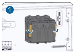
1 Suelte los cierres a presión de la caja de conexiones
